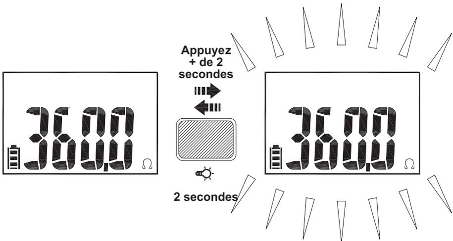
Appuyez sur le bouton de fonction pendant plus de 2 secondes pour activer ou désactiver le rétroéclairage.
