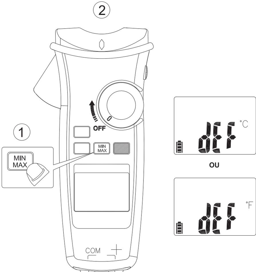
Appuyez sur le bouton MIN/MAX et maintenez-le enfoncé au moment de la mise sous tension de l'instrument pour sélectionner C° ou F°.
