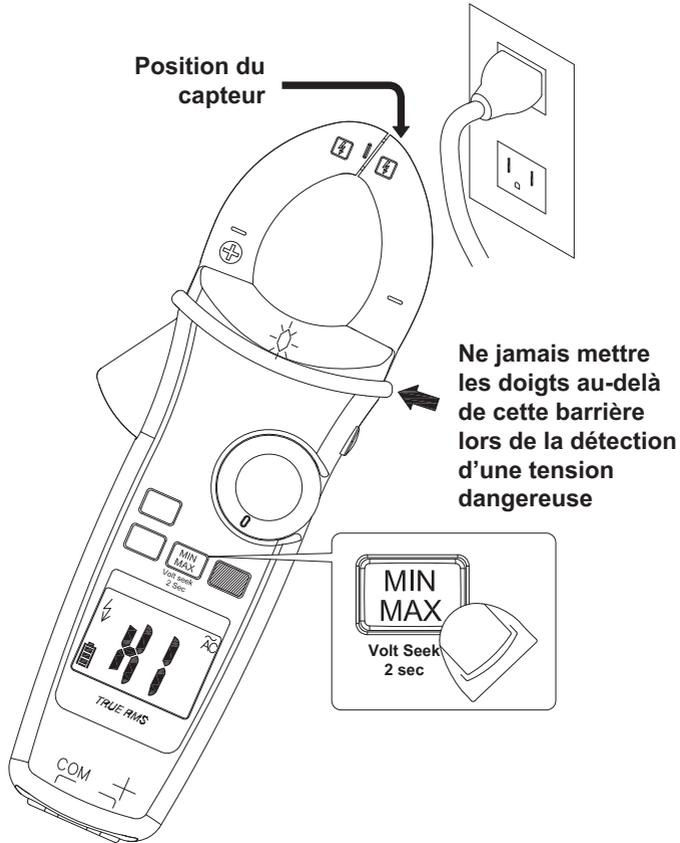
Appuyez sur le bouton MIN/MAX pendant plus de 2 secondes pour activer/désactiver le mode Volt Seek. Appuyez sur le bouton MIN/MAX pour passer d'une sensibilité élevée à faible.
