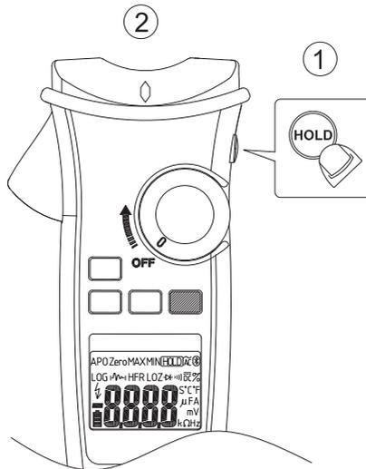
Mettez l'instrument sous tension tout en maintenant le bouton HOLD enfoncé.
