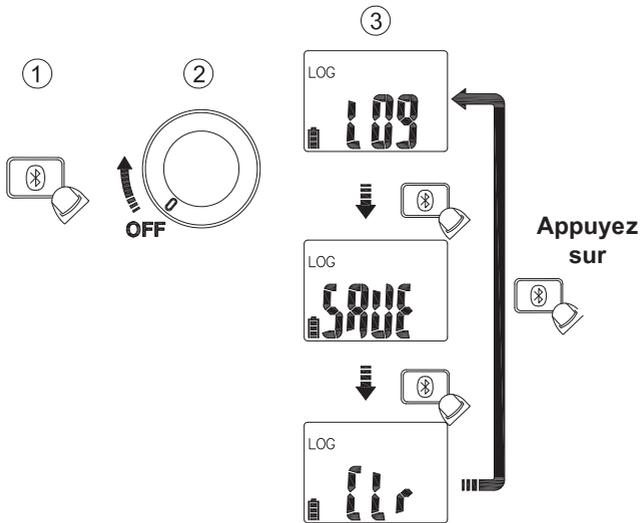
Appuyez sur le bouton Bluetooth® lors de la mise sous tension pour sélectionner le mode LOGGER (Enregistreur), le mode MANUAL SAVING (Enregistrement manuel) ou effacer la mémoire (Clr).
