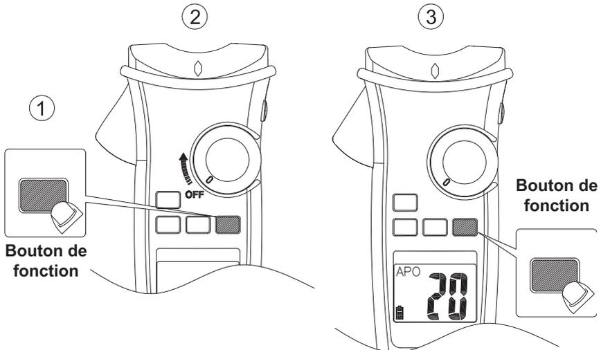
Appuyez sur le bouton de fonction et maintenez-le enfoncé au moment de la mise sous tension de l'instrument. Ce dernier émet 3 bips sonores avant l'activation de la fonction de mise hors tension automatique.
