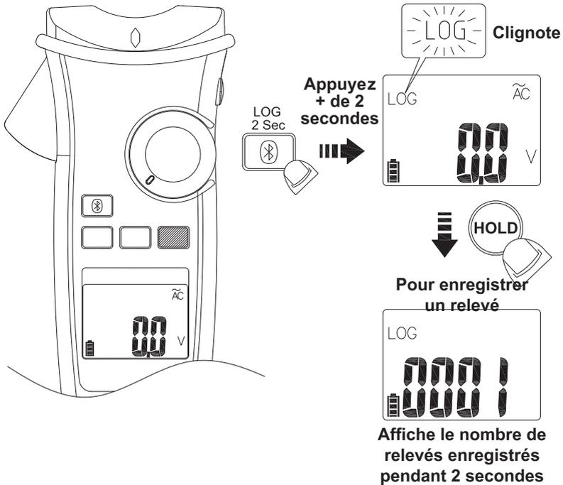
Si le mode MANUAL SAVING est sélectionné, des relevés peuvent être stockés en appuyant sur le bouton HOLD/ZERO en mode LOG. L'emplacement de l'échantillon est affiché à chaque appui sur le bouton.
