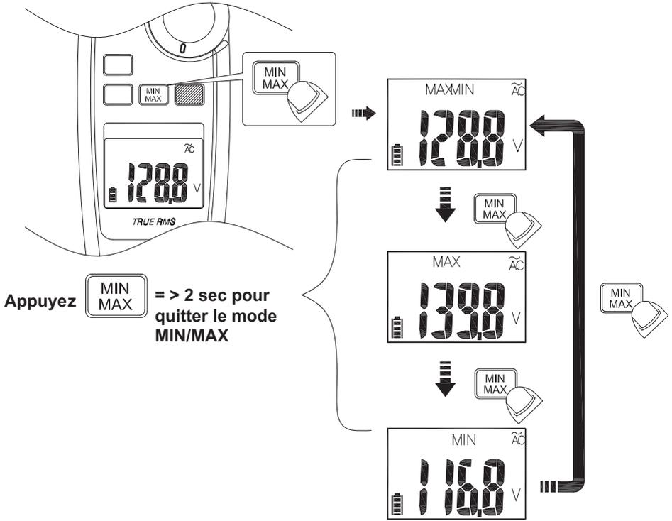
Le mode MIN/MAX permet d'enregistrer les valeurs de mesure min. et max.
