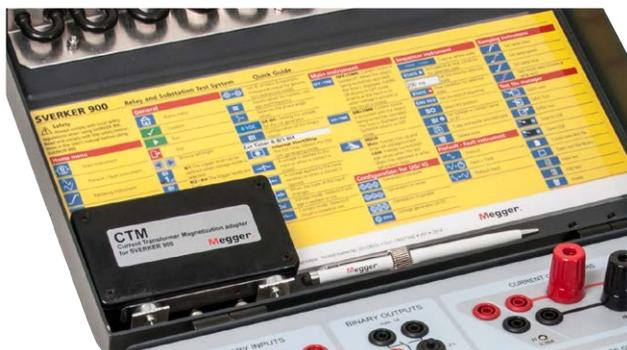
L'instrument de magnétisation de TC s'utilise pour déterminer la tension du point de coude d'un transformateur de courant.
