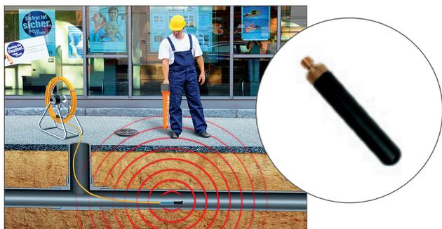
L'émetteur MLS 55-3 est une sonde émettrice fonctionnant sur batterie avec une portée de 5 m. Attaché à une tige d'évacuation ou à un câble en fibre de verre avec l'un des trois adaptateurs fournis, il permet de localiser les canalisations d'assainissement ou des tuyauteries bouchées. Un étui de protection est disponible.
