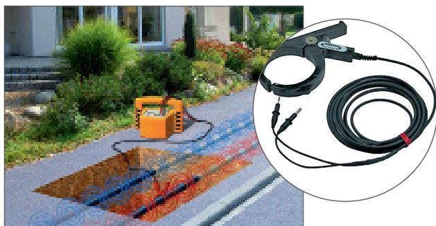
La pince à induction Easyclamp permet d'émettre le signal 33kHz sur des réseaux BT en exploitation. La pince est connectée à l'émetteur Easyloc TX et installée autour du câble, pour un traçage efficace.
