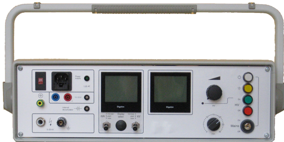
Figure 1 Equipement de test HT 25 kV
