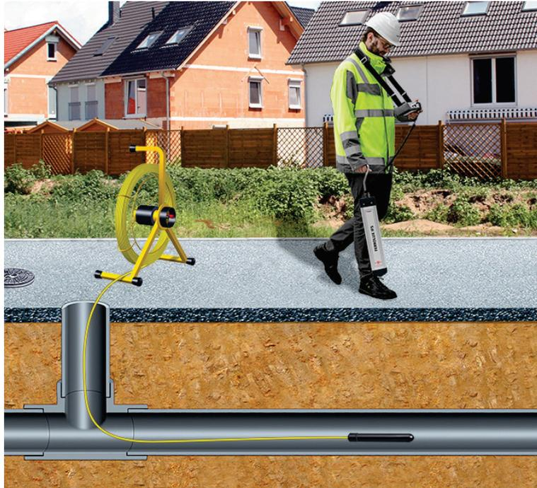
Si le récepteur est positionné directement au dessus de la sonde et que les 2 sont alignés, un signal maximum sera mesuré.
