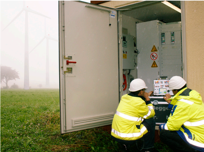
En détectant l'îlotage des systèmes décentralisés, l'instrument Rampe du SVERKER 900 aide à protéger les opérateurs des réseaux.
