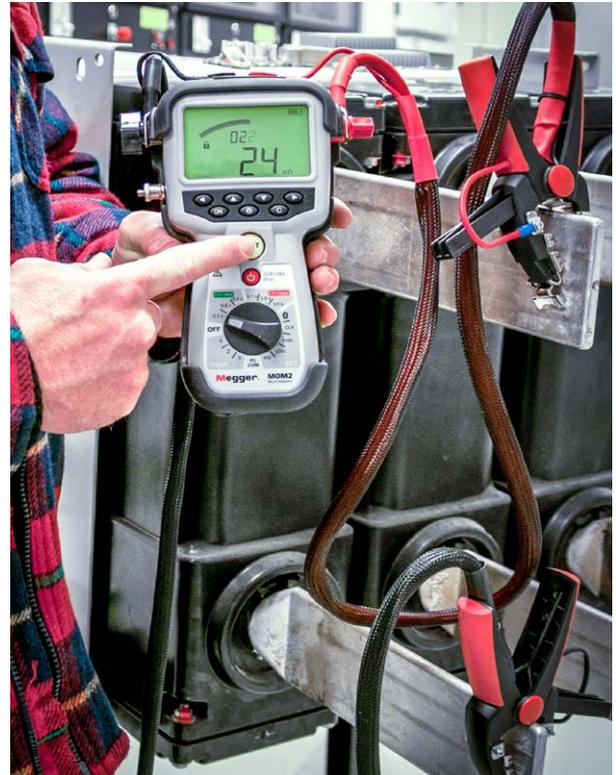
Maintenir les pointes de touche /Raccorder les pinces KELVIN sur le disjoncteur et appuyer sur le bouton Test. Un signal indique si le test est Bon ou mauvais et le résultat est enregistré dans l'instrument pour être téléchargé vers un PC.
