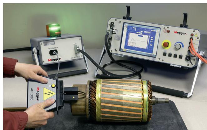
Test d'un induit à l'aide de l'accessoire ZTX et de la sonde collecteur ATF5000.
