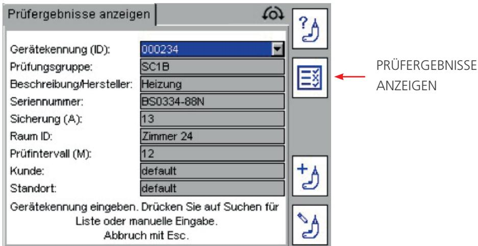
5. Drücken Sie den Hotkey „PRÜFERGEBNISSE ANZEIGEN“ („VIEW TEST RESULTS“)
