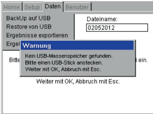
Dieser Fehler kann durch einen defekten USB-Stick verursacht werden. Tauschen Sie den USB-Stick gegen einen eines anderen Modells aus und versuchen Sie es erneut. (This error can be caused by a faulty USB stick. Replace the USB stick with another type and try again.) Hinweis: Es kann einige Sekunden dauern, bis der USB-Stick vom PAT400 erkannt wird.
