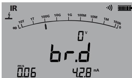
Auf diese Weise vereinfacht sich die Erkennung des Fehlerorte und es wird ein akustisches Signal ausgegeben - es handelt sich jedoch um eine zerstörende Prüfung.
