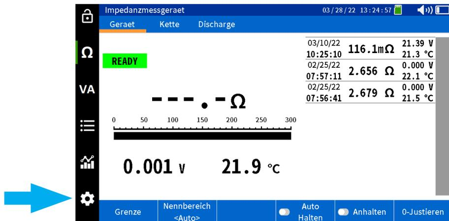
Auf der Registerkarte Impedanz kann die Temperaturmessskala (Celsius oder Fahrenheit) ausgewählt werden.
