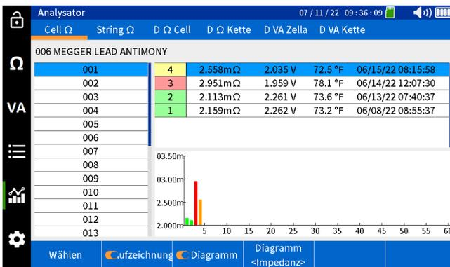
Wählen Sie „Diagramm“, um den Parameter zu ändern, für den ein Verlauf erstellt wird.
