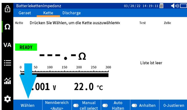
Wählen Sie den gewünschte Strang aus. Wählen Sie „New Test“ (Neue Prüfung), um eine neue Prüfung für den ausgewählten Strang zu starten.
