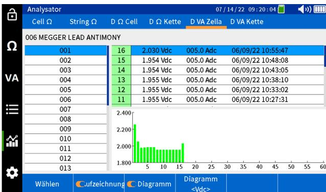
Wählen Sie „Diagramm“, um den Parameter zu ändern, für den ein Verlauf erstellt wird.
