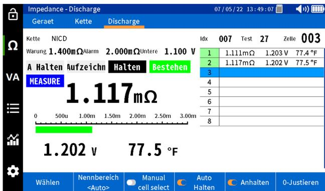
Wenn das Ende des Strangs erreicht ist, fordert das Gerät den Benutzer auf, entweder die Prüfung zu beenden oder auf „Next“ (Weiter) zu klicken, um den nächsten Durchlauf des Strangs durchzuführen.
