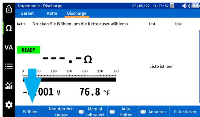
Wählen Sie den gewünschten Batteriestrang aus, und drücken Sie dann entweder auf „Select Test“ (Prüfung auswählen), um eine Prüfung fortzusetzen, oder „New Test“ (Neue Prüfung), um eine neue Prüfung zu starten.
