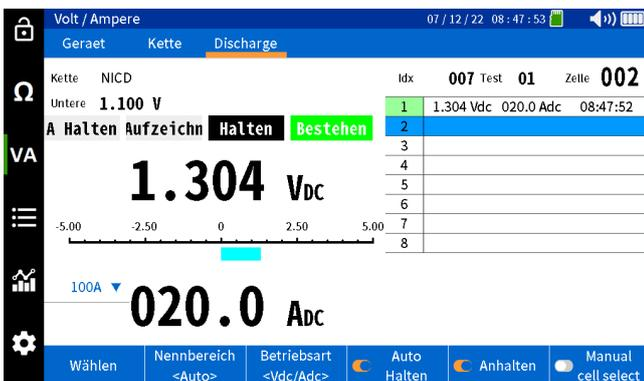
Messen Sie folgende Zellen. Jede Messung wird nacheinander mit einer Zellennummer, einem Datum und einem Zeitstempel gespeichert.
