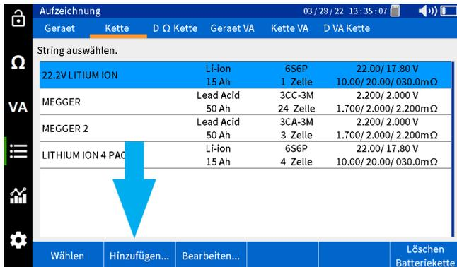
Daraufhin wird der Bildschirm „Strangkonfiguration“ geöffnet.
