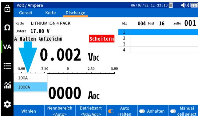
Führen Sie die Messung der ersten Zelle durch. Die Gleichspannung und der Gleichstrom werden mit einem Datums- und Zeitstempel gespeichert.
