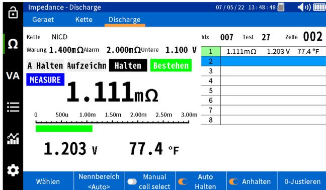
Messen Sie folgende Zellen. Jede Messung wird nacheinander mit einer Zellennummer, einem Datum und einem Zeitstempel gespeichert.
