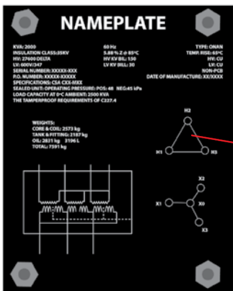
Porównanie grup połączeń wyświetlanych na ekranie z informacją z tabliczki znamionowej
