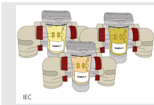
Fig. 1: Almacenamiento de las muestras de aceite según la IEC
