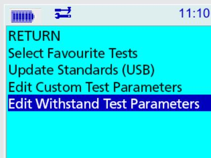
En la pantalla de parámetros de tensión no disruptiva se muestra un conjunto de variables que controlan una medida de tensión no disruptiva. El usuario puede configurar las distintas variables. Solo tiene que desplazarse hacia abajo hasta el parámetro deseado, pulsar el botón "OK" (Aceptar) y proceder a cambiar el valor según sea necesario.
