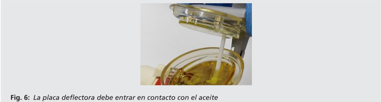
**Fig. 6:** La placa deflectora debe entrar en contacto con el aceite
