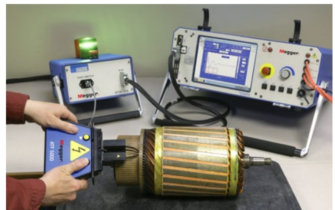
Testowanie twornika przy użyciu akcesoriów ZTX oraz ATF5000.
