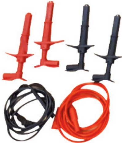
Conjunto de cables de puente de 0,5 m (se utilizan para unir los núcleos del cable al núcleo que se está midiendo)
