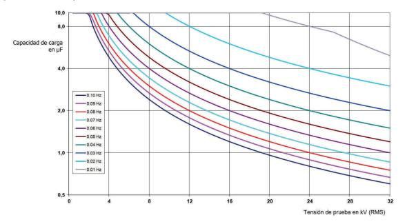
Para **Tensión rectangular de coseno y tensión alterna amortiguada (DAC)** (módulo Boost necesario) se aplica de forma análoga el siguiente diagrama de carga<sup>1</sup>:
