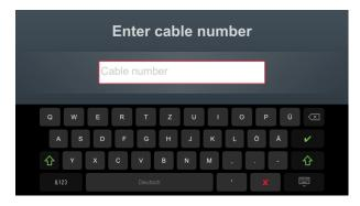
Introducir el número de cable con la mayor precisión posible facilita la asignación posterior al crear un informe y archivar el conjunto de datos de medición en el software de registro. Si no se prevé dicho procesamiento posterior, no es necesario introducir el número de cable. Si se ha introducido o no un número de cable, es necesario confirmarlo con .
