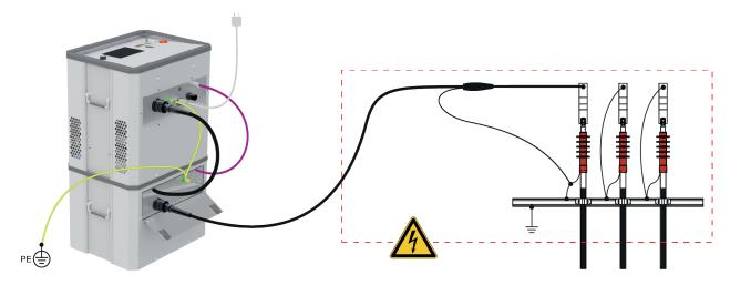
Proceda como se indica a continuación para conectar el sistema con el objeto de pruebas:
