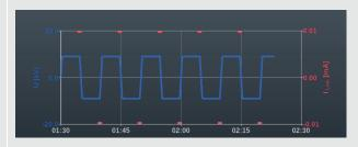
En el modo CC, a partir de un tiempo de prueba de alrededor de 90 segundos, también se muestra permanentemente una flecha roja en el diagrama, que muestra la tendencia de las corrientes de fuga medidas (valor medido actual en comparación con el valor medido después de que se completa el proceso de carga).
