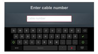
Introducir el número de cable con la mayor precisión posible facilita la asignación posterior al crear un informe y archivar el conjunto de datos de medición en el software de registro. Si no se prevé dicho procesamiento posterior, no es necesario introducir el número de cable. Si se ha introducido o no un número de cable, es necesario confirmarlo con .
