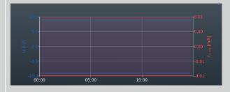
En este tipo de gráfico pueden leerse fácilmente tanto eventos a corto plazo (como una breve caída de tensión o un pico de corriente de fuga) como la tendencia a largo plazo de los valores de corriente de fuga.
