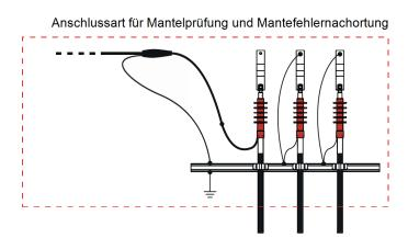
Gehen Sie wie folgt vor, um die Prüfanlage mit dem Prüfling zu verbinden:
