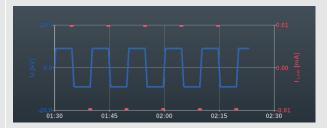
Im DC-Betrieb wird ab etwa 90 Sekunden Prüfzeit zusätzlich permanent ein roter Pfeil im Diagramm angezeigt, der den Trend der gemessenen Ableitströme anzeigt (aktueller Messwert im Vergleich zu dem nach Abschluss des Ladevorgangs gemessenen Wert).
