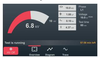
Dieser zeigt neben der aktuellen Prüfspannung und der verbleibenden Prüfdauer je nach Betriebsart auch noch die folgenden Messwerte an:
