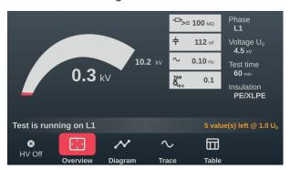
Dieser zeigt neben der aktuellen Prüfspannung und der verbleibenden Prüfdauer (bzw. den verbleibenden Messwerten beim Stufentest) auch noch die folgenden Messwerte an:
