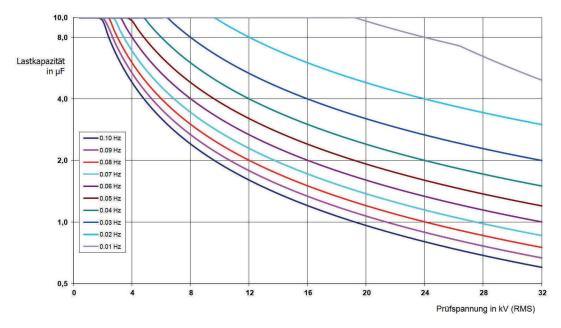
Für Cosinus-Rechteck-Spannung und gedämpfte Wechselspannung (DAC) (Boost-Modul erforderlich) gilt analog dazu das folgende Lastdiagramm<sup>1</sup>:
