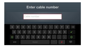
Eine möglichst exakte Eingabe der Kabelnummer erleichtert später bei der Berichterstellung und Archivierung des Messdatensatzes in der Protokollsoftware die Zuordnung zum Kabel. Ist eine solche Weiterverarbeitung nicht vorgesehen, kann auf die Eingabe der Kabelnummer verzichtet werden. Unabhängig davon, ob eine Kabelnummer eingegeben wurde oder nicht, ist eine Bestätigung über Verforderlich.
