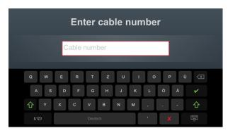
Eine möglichst exakte Eingabe der Kabelnummer erleichtert später bei der Berichterstellung und Archivierung des Messdatensatzes in der Protokollsoftware die Zuordnung zum Kabel. Ist eine solche Weiterverarbeitung nicht vorgesehen, kann auf die Eingabe der Kabelnummer verzichtet werden. Unabhängig davon, ob eine Kabelnummer eingegeben wurde oder nicht, ist eine Bestätigung über verforderlich.
