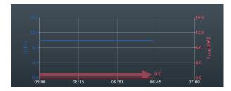
Über die Schaltfläche kann die Ansicht auf den Übersichtsbildschirm umgeschaltet werden. Dieser zeigt neben der aktuellen Prüfspannung auch den aktuellen Ableitstrom-Messwert an.
