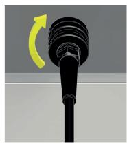
5. Befestigen Sie den Stecker des mitgelieferten HV-Anschlusskabels im HV-Ausgang 17 des Boost-Moduls. Auch hier ist auf die richtige Ausrichtung beim Einstecken zu achten.
