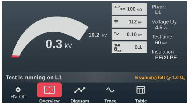
Dieser zeigt neben der aktuellen Prüfspannung und der verbleibenden Prüfdauer (bzw. den verbleibenden Messwerten beim Stufentest) auch noch die folgenden Messwerte an:
