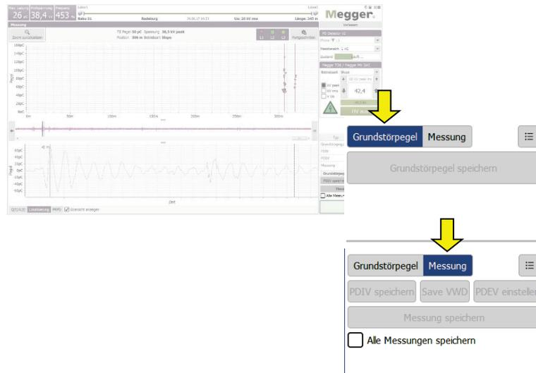
Standardmäßig muss jede abgeschlossene Einzelmessung manuell gespeichert werden. **Andernfalls verfallen die Daten mit dem Start der nächsten Einzelmessung!** Einige definierte Parameter wie z.B. PDIV und PDEV sind über eigens dafür vorgesehene Schaltflächen zu speichern. Sie werden dann innerhalb der Messdaten entsprechend gekennzeichnet und im Bericht gesondert ausgegeben. Zu diesem Zweck sind die folgenden Schaltflächen zu verwenden:
