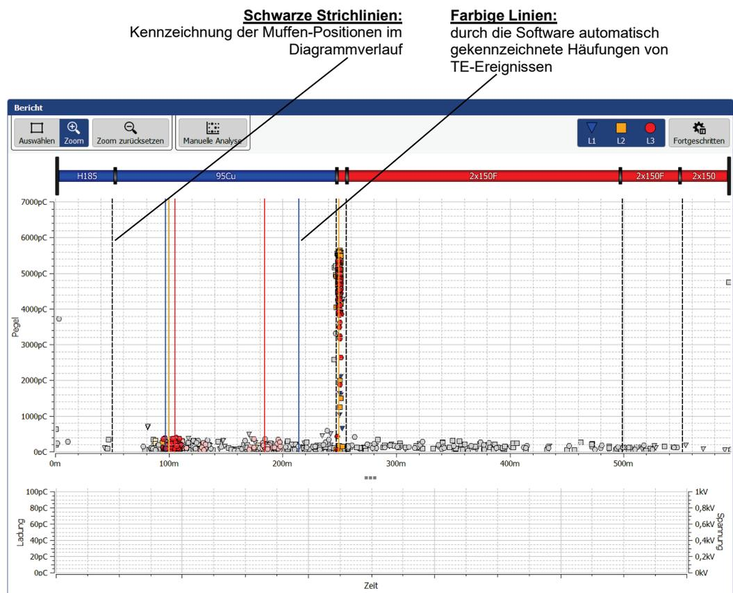
Zur Erstellung des TE-Mappings wird schon während der Messung mit Hilfe geeigneter Algorithmen und Filter eine automatisierte Bewertung der gemessenen Ladungsimpulse durch die Software vorgenommen. Dabei werden nicht nur der Pegel sondern auch andere Charakteristika des Impulses, wie z.B. Phasenlage und Flanken, betrachtet. Im Ergebnis dieser Auswertung wird meist schon der übermäßige Teil der Störer identifiziert und verworfen.
