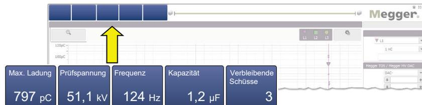
Je nach Einstellung der Prüfparameter wird eine Auswahl der folgenden Werte angezeigt:
