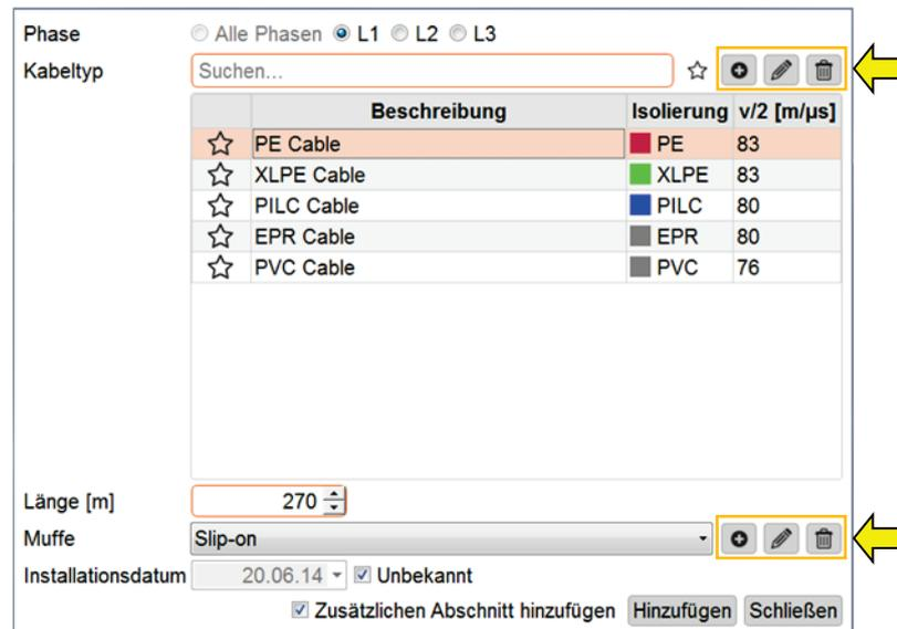
*Kabelvorlage anlegen / bearbeiten* Über die Schaltflächen kann eine neue Kabelvorlage angelegt bzw. die aktuell ausgewählte Kabelvorlage bearbeitet werden. Nach Betätigung der Schaltfläche öffnet sich ein neues Fenster, in welchem die folgenden Eigenschaften der Vorlage definiert werden können:
