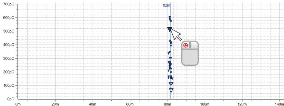
Die Auswahlbox links oberhalb des TE-Mappings legt fest, ob durch Ziehen eines Rahmens bei gedrückter Maustaste in den markierten Bereich hineingezoomt oder die in diesem Bereich befindlichen TE-Ereignisse selektiert werden.
