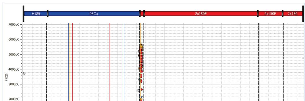
Diese Ansicht eignet sich insbesondere dazu, eine Zuordnung der diagnostizierten TE-Fehlstellen zu bestimmten Merkmalen (z.B. Muffen, Isolationstypen) des Kabels vorzunehmen. Ein geringer Versatz zwischen der Position der Garnitur und der TE-Fehlstelle kann dabei häufig auf einen ungenauen Kabelplan oder eine vom tatsächlichen Wert abweichende Ausbreitungsgeschwindigkeit zurückgeführt werden.
