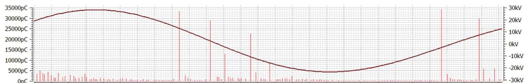
**Manuelle Klassifizierung** Wenn bei der genaueren Analyse von TE-Ereignissen Zweifel an der automatisch vorgenommenen Klassifizierung aufkommen und diese manuell korrigiert werden sollen, kann über die Schaltfläche **Manuelle Analyse** eine zusätzliche Symbolleiste eingeblendet werden.
