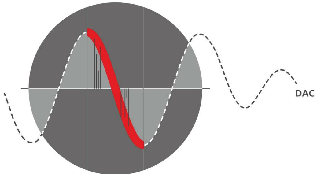
Insbesondere für die TE-Diagnose ist dies äußerst wichtig, da für eine zuverlässige Evaluierung der Messergebnisse eine direkte Vergleichbarkeit mit der Netzfrequenz gegeben sein muss. Es ist allgemein bekannt dass die TE-Charakteristiken sich bei großen Frequenzunterschieden ändern und deswegen keine zuverlässige Aussage mehr getroffen werden kann.
