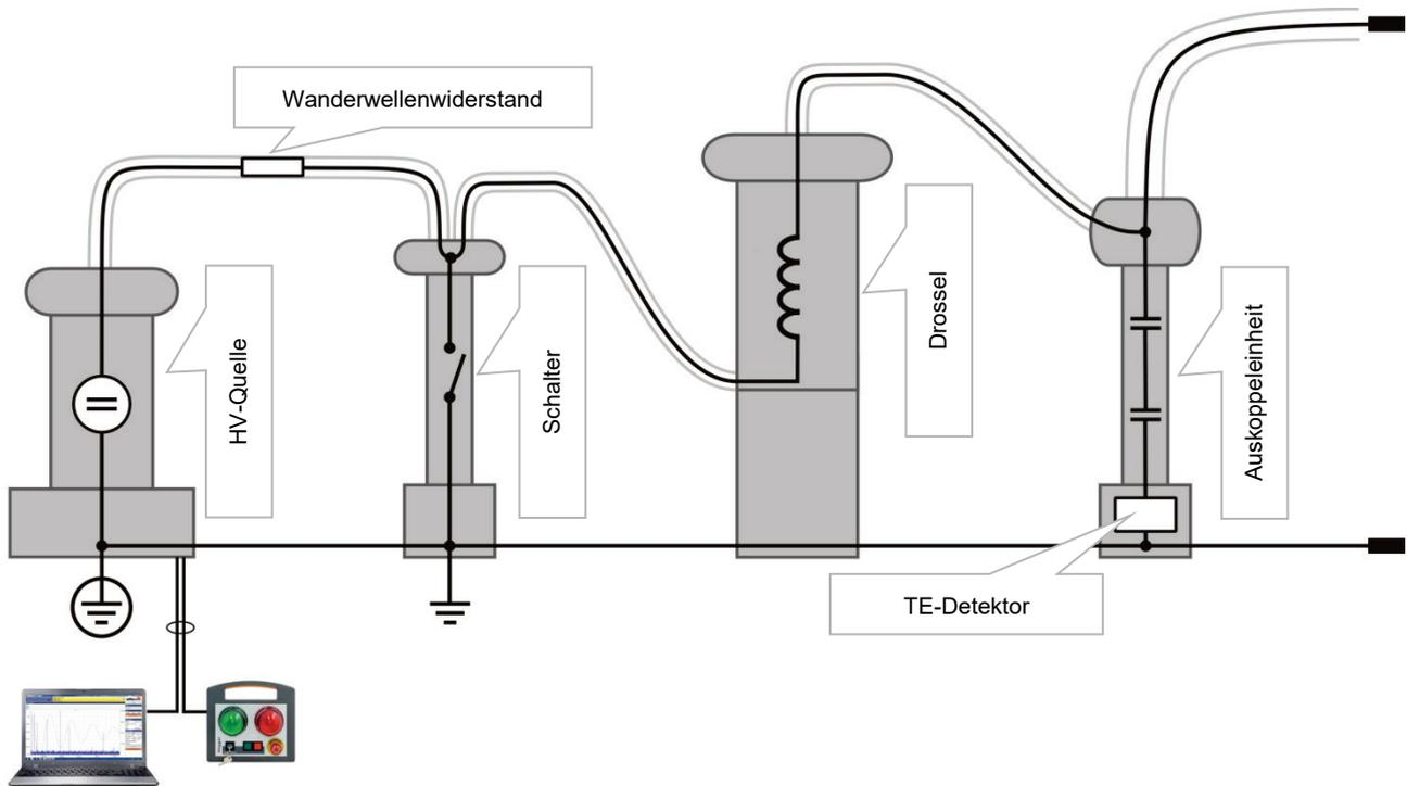
Die Steuerung der Spannungsquelle sowie die Anzeige und Auswertung der Messdaten erfolgt über ein mittels Netzwerkschnittstelle verbundenes Notebook. Mit Hilfe der vorinstallierten Software lassen sich sämtliche für die Messung und Lokalisierung von Teilentladungen notwendigen Bedienhandlungen durchführen. Die Auswertung und Verwaltung der Messdaten kann dabei je nach Belieben entweder direkt nach der Messung oder später im Büro durchgeführt werden.
