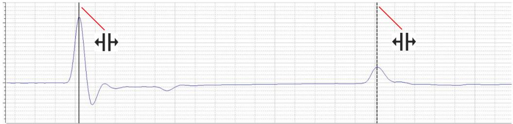
Über die Checkbox **Entfernungscursor anzeigen** kann ein zusätzlicher Marker eingeblendet und entlang der Kurve verschoben werden. Dieser gestattet es zum Beispiel, die Positionen von Muffen einzumessen und später manuell in den Kabelplan einzupflegen.
