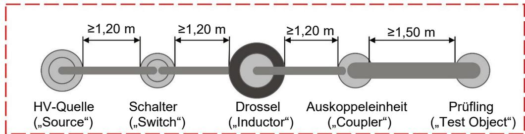
Alternativ können die Komponenten auch in einem Zickzack-Muster aufgebaut werden. In diesem Fall sind zusätzlich die folgenden Mindestabstände einzuhalten:
