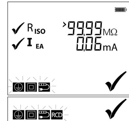
**Hinweis:** Hohe Berührungstrommessungen an fehlerhaften Geräten können einen RCD der Netzversorgung auslösen.
