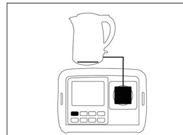
Schließen Sie den Prüfling an das Messgerät an.
