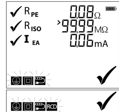
**Hinweis:** Wenn das Kontaktsymbol
