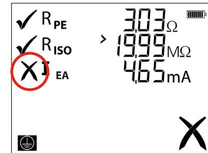
ii) Gesamter MANGELHAFTER Test wird durch ein großes Kreuz gekennzeichnet:
