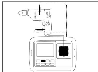
Verbinden Sie die P1-Testleitung während der Messung mit unterschiedlichen leitenden Punkten auf dem zu prüfenden Gerät
