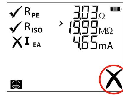
**Hinweis:** Falls ein Gerät einen Test nicht bestanden hat, werden aus Sicherheitsgründen weitere Tests der Testgruppensequenz mit Ausnahme des Verlängerungskabeltests verhindert.
