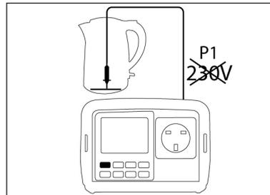
Schließen Sie die P1 Testleitung an die Buchse P1 am PAT 100 an und die Prüfspitze gegen/an das zugängliche Metallgehäuse. Stellen Sie sicher, dass die Prüfspitze NICHT mit einer 230 V Spannungsquelle verbunden ist.
