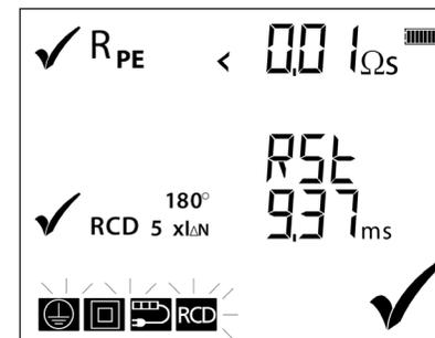
**Hinweis:** Das PAT150 ist standardmäßig auf 30 mA RCD eingestellt. Um auf 10 mA zu ändern, halten Sie die RCD-Taste für mehr als 2 Sekunden gedrückt.
