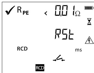
v) Drücken Sie die TEST-Taste am RCD
