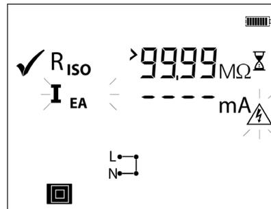
Wenn das L zu N Kurzschluss-Symbol angezeigt wird, muss der Benutzer überprüfen, ob es sich um einen echten Kurzschluss handelt. Drücken Sie die Klasse 2 Taste, um fortzufahren, aber es besteht die Gefahr der Beschädigung oder Auslösung von Schutzeinrichtungen.
