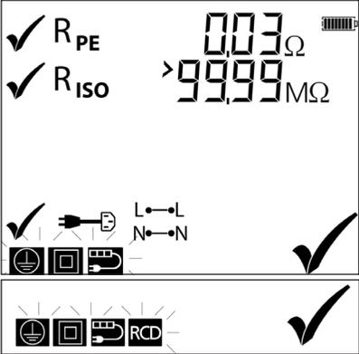
**Hinweis:** Mehrere Schutzleiter-Durchgangsprüfungen können durchgeführt werden, indem bei der Durchgangsprüfung die QT-Taste gedrückt und bei jeder neuen Durchgangsprüfung diese Taste erneut gedrückt wird. Siehe Seite 13.
