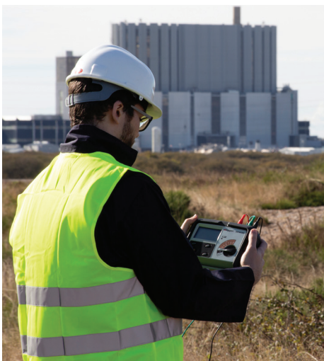
Üblicher Einsatz eines digitalen Megger Erdwiderstandsmessgeräts – des DET4TC – zur Durchführung von Spannungsabfallprüfungen.
