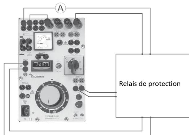
Connexion classique de test de relais de protection
